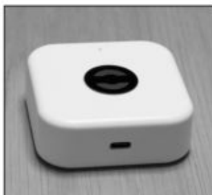
Gateway - connexion pour environ 20 serrures
